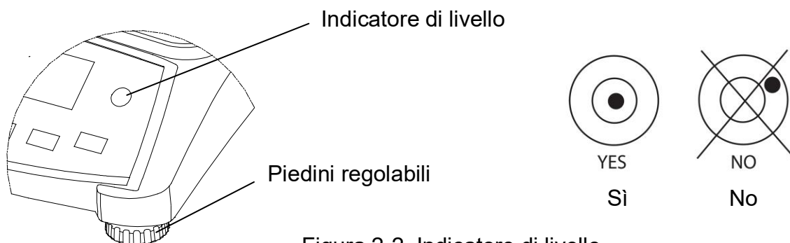
Figura 2-2. Indicatore di livello
